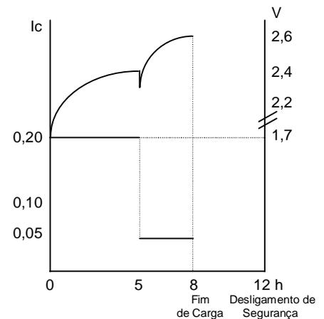
Caso a bateria não se carregue num tempo de 10 a 12 horas a partir de sua conexão ao carregador, este se auto desliga e sinaliza defeito.
